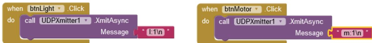
Wie die Namen der when-Klammern erkennen lassen, stammen sie aus dem Blockvorrat der Buttons btnLight und btnMotor. die Functioncalls stammen aus UDPXmitter1. Die Kommandostrings müssen mit einem Linefeed abgeschlossen werden, das erledigt das "\n".
