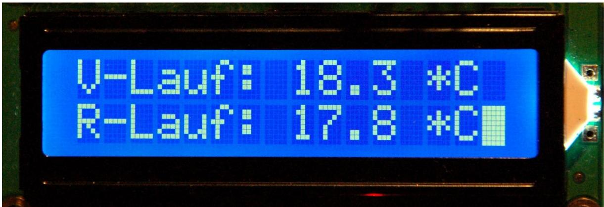
Abbildung 15: Heizung - Vorlauf - Rücklauf
