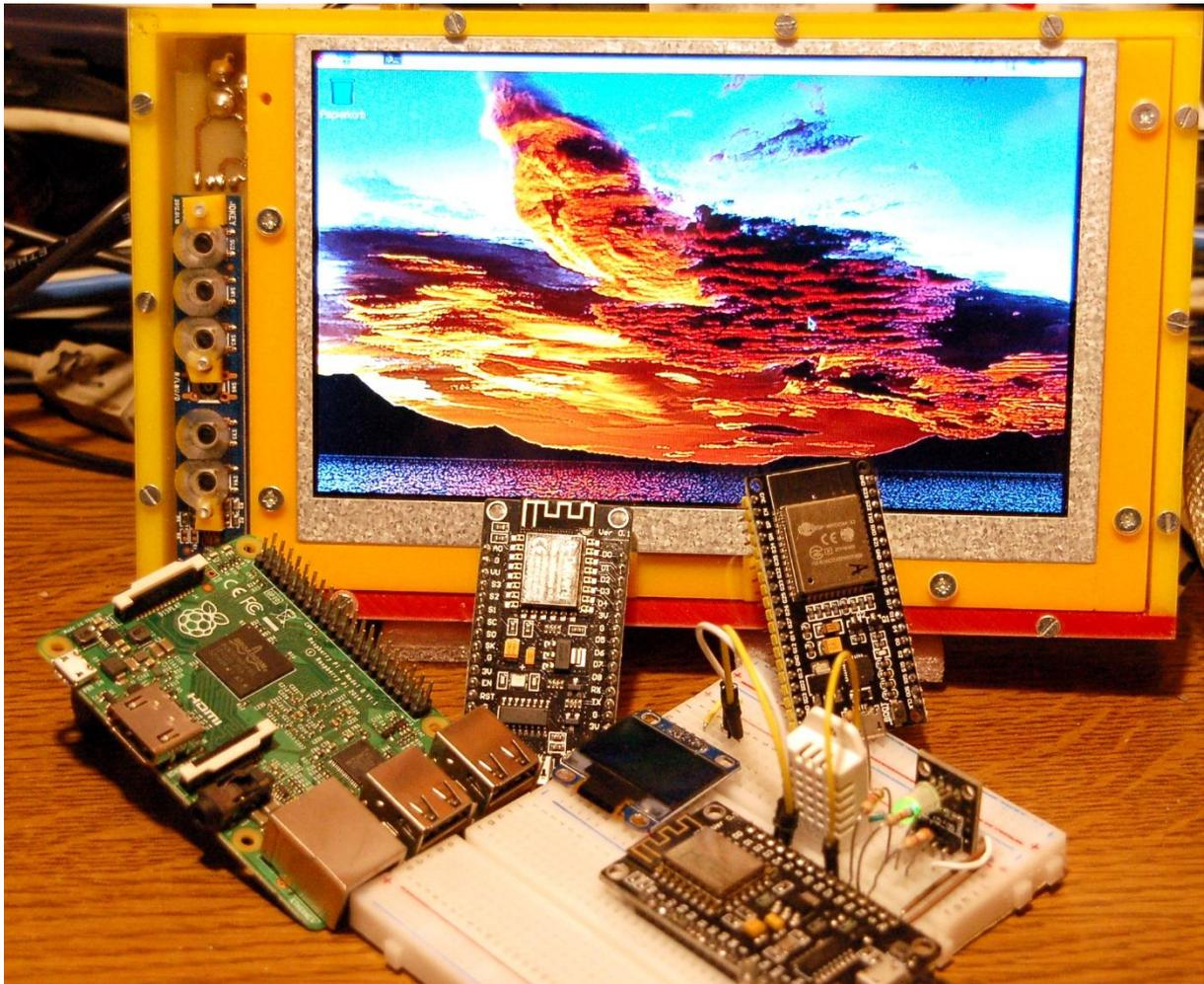
Abbildung 1: MQTT mit Raspi und ESP-Familie
