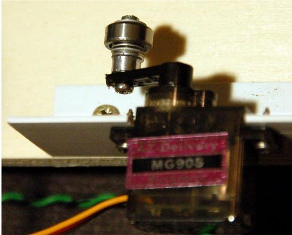
Abbildung 4: Servo mit Kugellager aus einer alten Festplatte am Hebel
