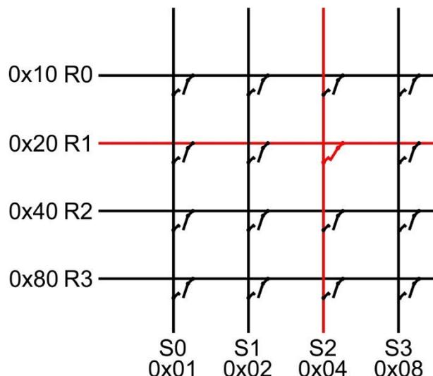
In der folgenden j-Schleife werden die Zeilenleitungen von oben nach unten der Reihe nach einzeln auf GND-Pegel gesetzt. Die eingeschlossene k-Schleife prüft nun, ob eine der Spaltenleitungen auf 0-Potenzial liegt. In diesem Fall bilden wir den rohen Tastencode aus Zeilen- und Spaltennummer. Die Zeilennummer j liefert das höherwertige Nibble des **code**-Bytes, die Spaltennummer das niederwertige Nibble. Dann setzen wir den
