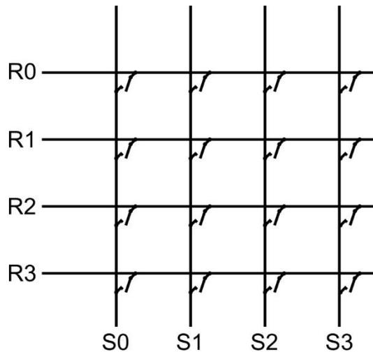
Die Tasten sitzen an den Kreuzungspunkten der Zeilen- und Spaltendrähte. Wird eine Taste gedrückt, dann wird eine bestimmte Zeilenleitung mit einer genau definierten Spaltenleitung verbunden. Aufgabe unseres Programms ist es jetzt, herauszufinden, wer mit wem verbunden ist. Dafür gibt es verschiedene Algorithmen. Zwei davon stelle ich Ihnen hier vor. Die Vorgehensweise orientiert sich an der Art der Verdrahtung und der Hardware der vorhandenen Schnittstellen.
