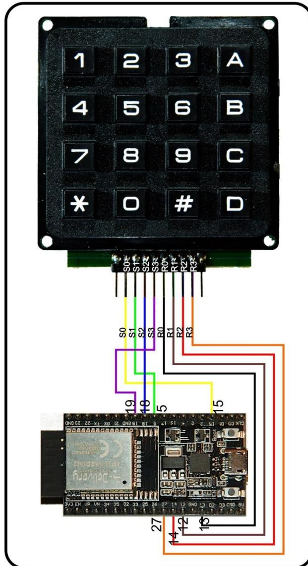
Die Tastenabfrage ist in Form der Klasse `KEYPAD_P` gelöst, die ich in das Modul `keypad.py` integriert habe. Im gleichen Zug wurde die Tastenabfrage des LCD-Keypads so angepasst, dass sich auch dafür dieselbe API ergibt. Bei allen Klassen gibt es eine Methode `key()`, die angesprochen wird, wenn das aufrufende Programm eine Tastenbetätigung wünscht.
