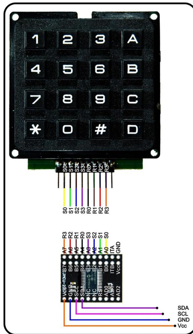
Angesteuert wird der MCP23017 über den I2C-Bus und damit parallel zum Display und evtl. zum BMP280, falls der noch in der Schaltung ist. Das ist möglich, weil alle Schnittstellen unterschiedliche Hardwareadressen haben. Übrigens, passen Sie auf, dass Sie wirklich einen MCP23017 bekommen. Sein Brüderchen, der MCP23S17, wird über den SPI-Bus angesteuert und ist hier nicht brauchbar.
