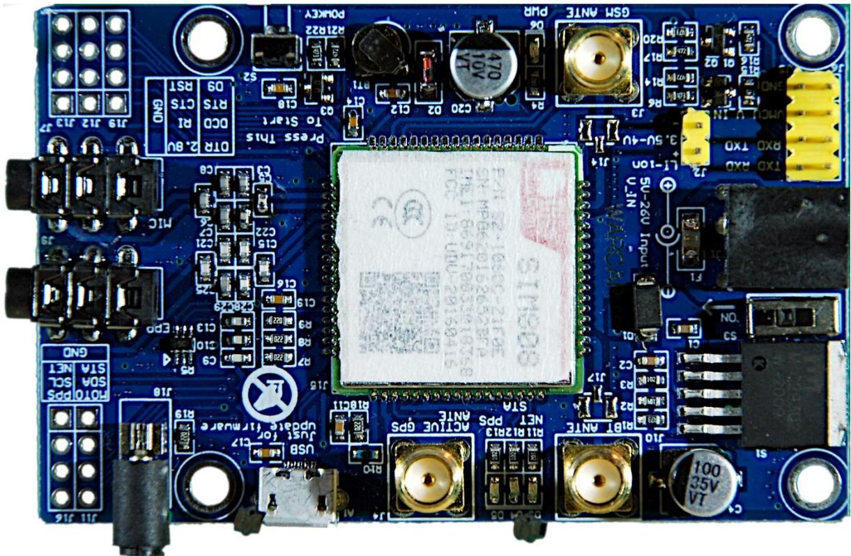
An der Beschaltung des SIM808 hat sich vom ersten Teil her nichts geändert. Dazu ist auch nicht viel zu sagen. Gerade mal vier Leitungen sind für die Verbindung zum ESP32 nötig, GND, TXD, RXD und die Leitung von der Starttaste des SIM808 zum GPIO4-Pin des ESP32. Die nächste Abbildung zeigt den Anschluss dieser Leitung am SIM808-Board.
