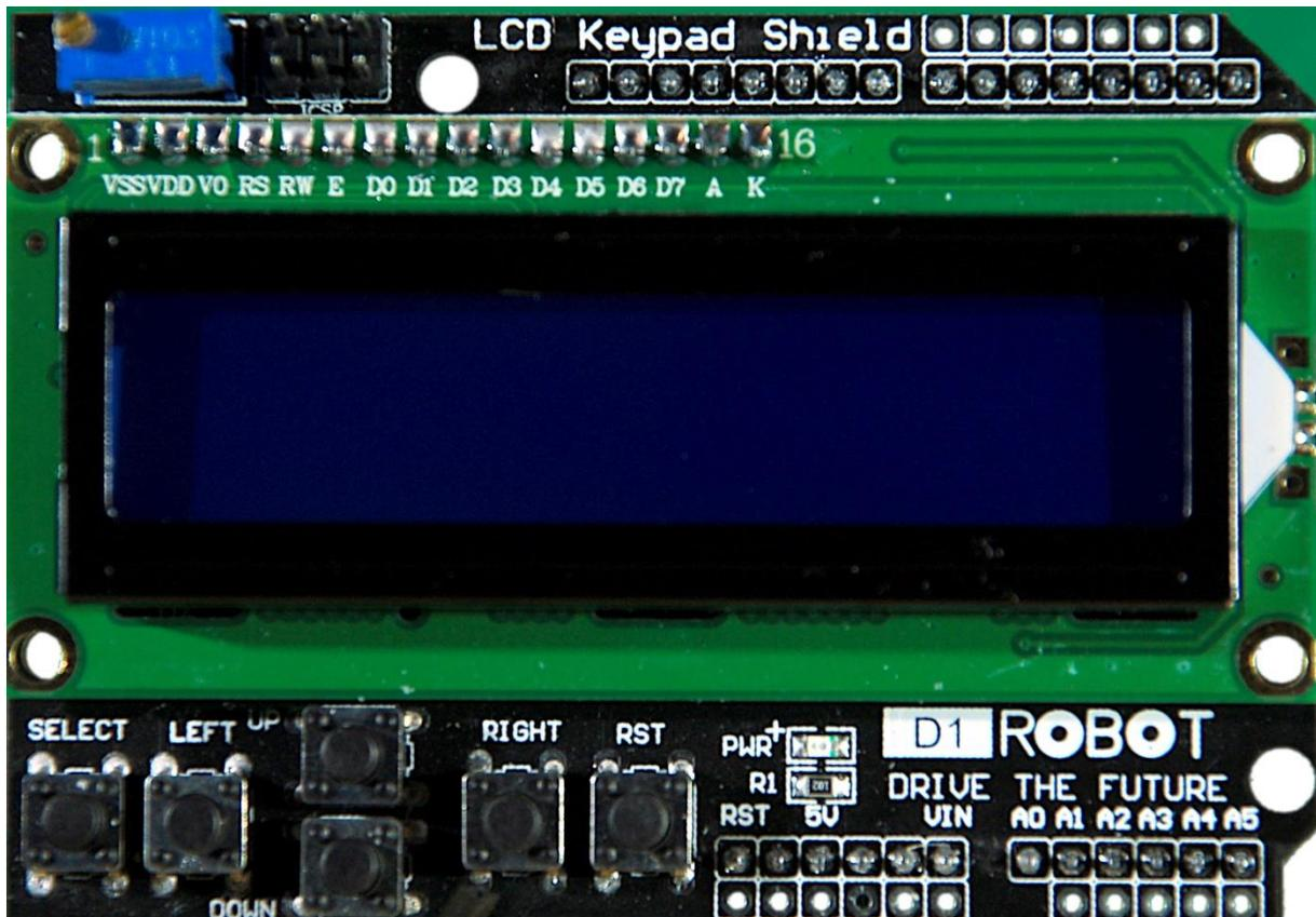
Das Display mit Keypad bietet neben der 16x2-Darstellung insgesamt 6 Tasten, von denen alle im aktuellen Projekt eine Steuerfunktion zu erfüllen haben. Fünf dieser Tasten liefern die Spannung von den Knotenpunkten einer Widerstandskaskade an einen ADC-Eingang (GPIO35) des ESP32. Die Pegel werden vom ESP32 decodiert und verschiedenen Aktionen zugeordnet. Dazu erfahren Sie später Genaueres.
