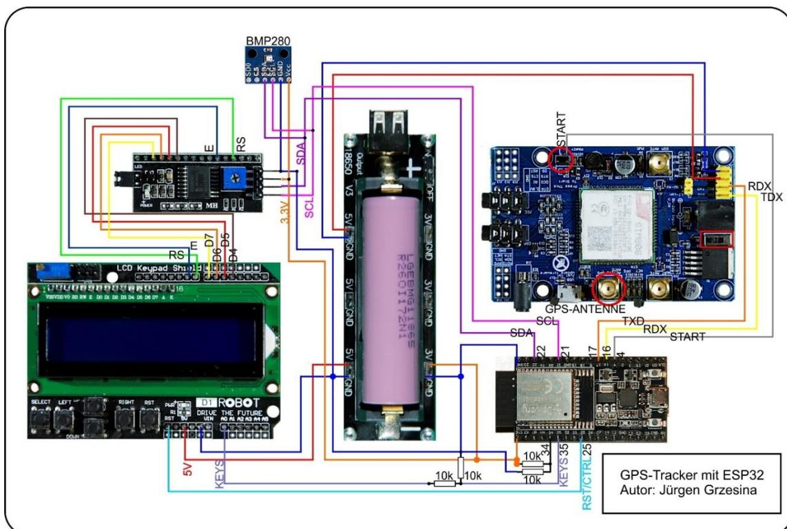
Ein paar Bemerkungen zur Schaltung sollen deren Funktion klarstellen. Das LCD-Keypad wird mit 5V versorgt, das habe ich oben schon erwähnt. Der ESP32 arbeitet aber mit maximal 3,3V für die Versorgungsspannung und für die GPIO-Pins. Deshalb müssen die 5V-Pegel an den Ein- und Ausgängen des LCD und des Keypads auf ESP32-verträgliche Werte reduziert werden. Das geschieht durch den Spannungsteiler aus den beiden 10kΩ-Widerständen.
