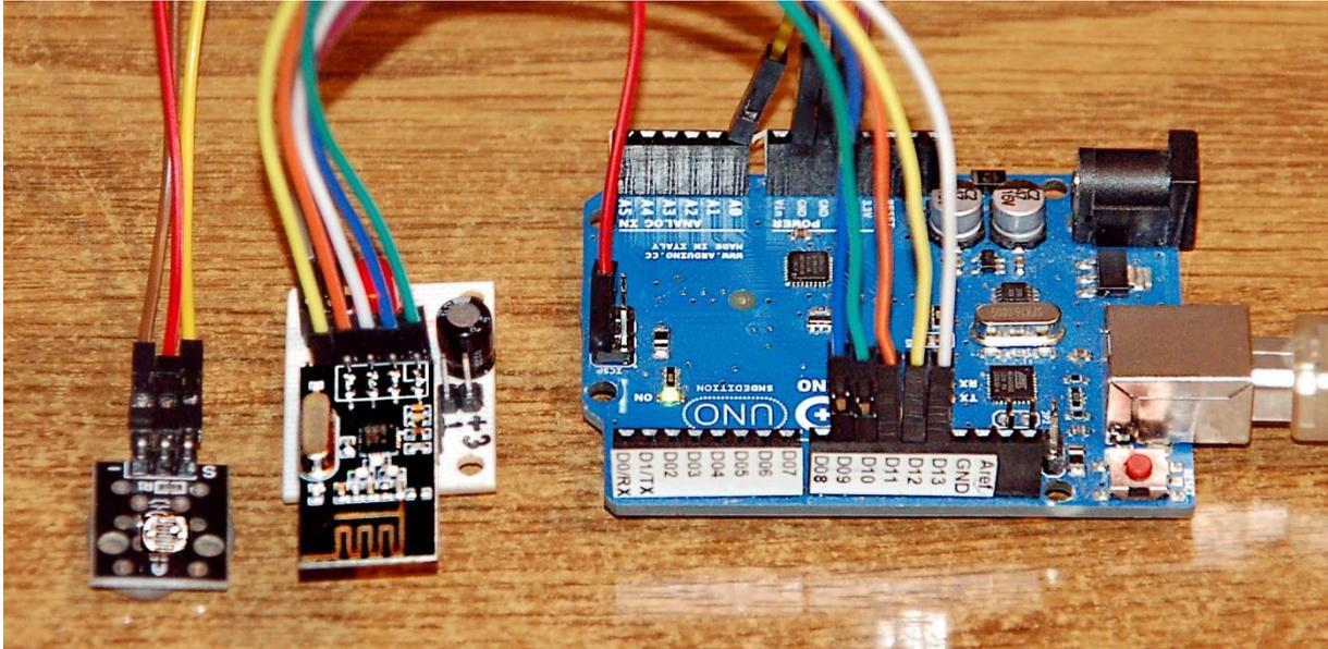
Abbildung 1: LDR, nRF24L01 und Arduino UNO
