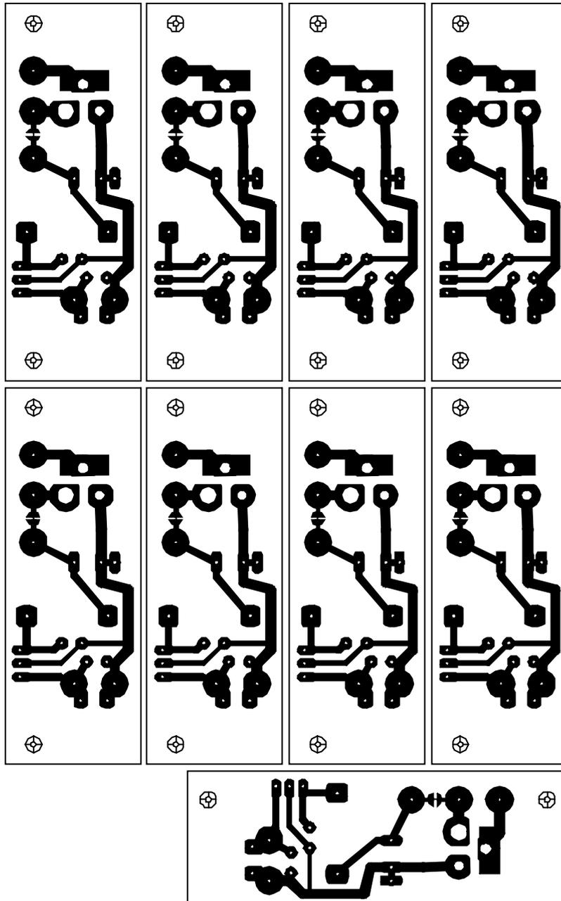
5V-Regelung mit Rohrbuchse als Eingang
